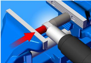
Spannen Sie das zusammengesetzte Werkzeug und den Stoßdämpfer in einen Schraubstock und pressen Sie die Lagerbüchse durch gleichmäßiges Spannen aus dem Stoßdämpfergehäuse. Die Lagerbüchse wird dabei in einen geschlossenen Bereich des Werkzeugs geschoben, aus dem sie einfach zu entfernen ist.
